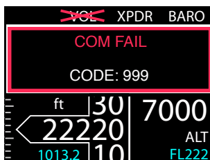
Figure 8.4.: Systemausfall im angeschlossenen Funkgerät, Fehlercode wird angezeigt. Nicht betroffene Systeme sind weiterhin funktionsfähig.
